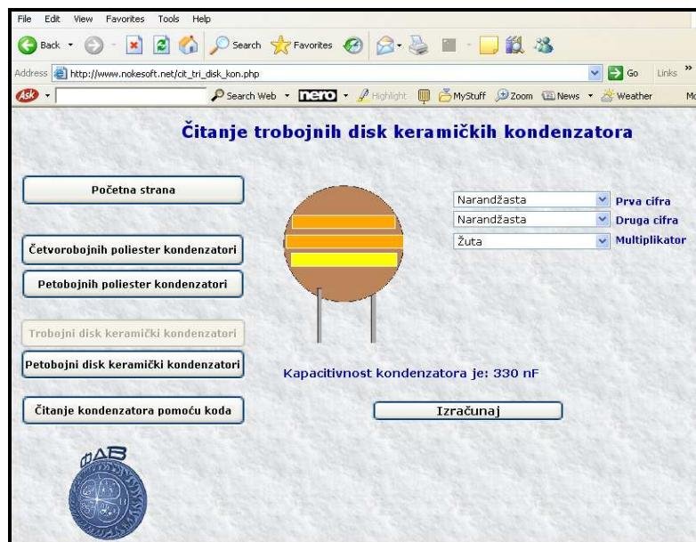
Sl. 6, izgled web strane za čitanje trobojnih keramičkih kondenzatora
