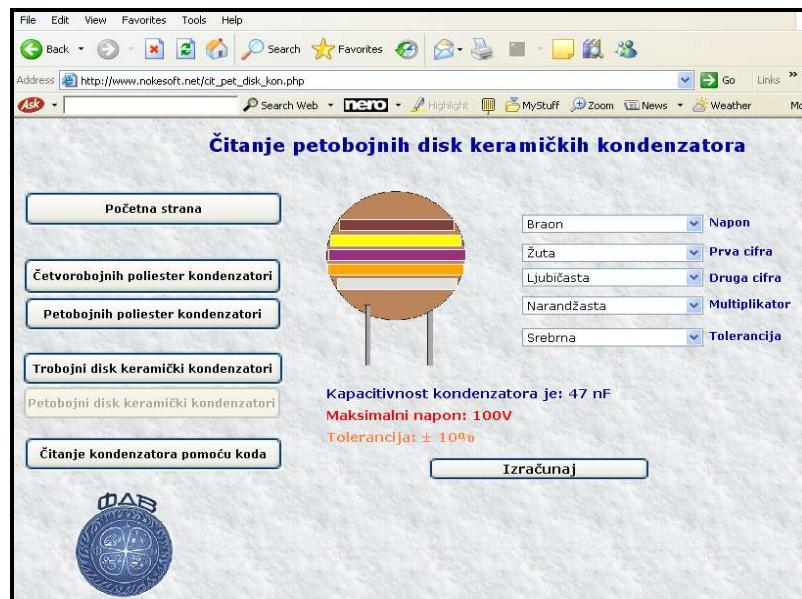
Sl. 7, izgled web strane za čitanje petobojnih keramičkih kondenzatora
