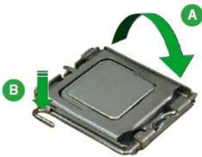
Slika 9, Postavljanje procesora u podnožje Picture 9, the processor in Socket
