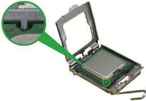
Slika 8, Postavljanje procesora u podnožje Picture 8, the processor in Socket
